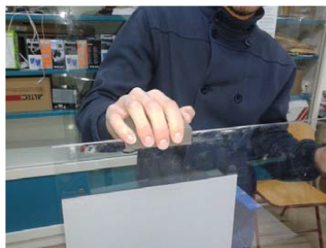
Εικόνα 10: Μέλος της ομάδας λειαίνει με γυαλόχαρτο το περίγραμμα της επιφάνειας ώστε να επιτευχθεί το φαινόμενο της Ολικής Εσωτερικής Ανάκλασης
